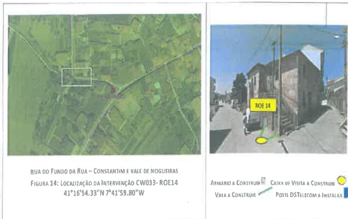
Imagem 14 – Constantim e Vale Nogueiras – Intervenção CW033 – ROE14: Colocação de armário de distribuição de fibra ótica, construção de caixa de visita permanente tudo pertencente à Derivadas e Segmentos, SA., abertura e fecho de valas de interligação entre a caixa de visita a construir, o armário a colocar e poste EDP existente, bem como a passagem de cabo em infraestruturas existentes.
