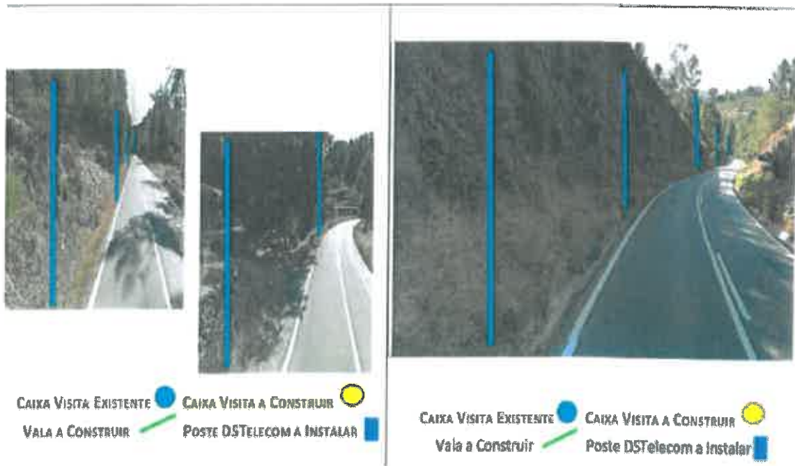
Imagem 5 – N313 – Andrães – Implantação de 16 postes DST em betão.
