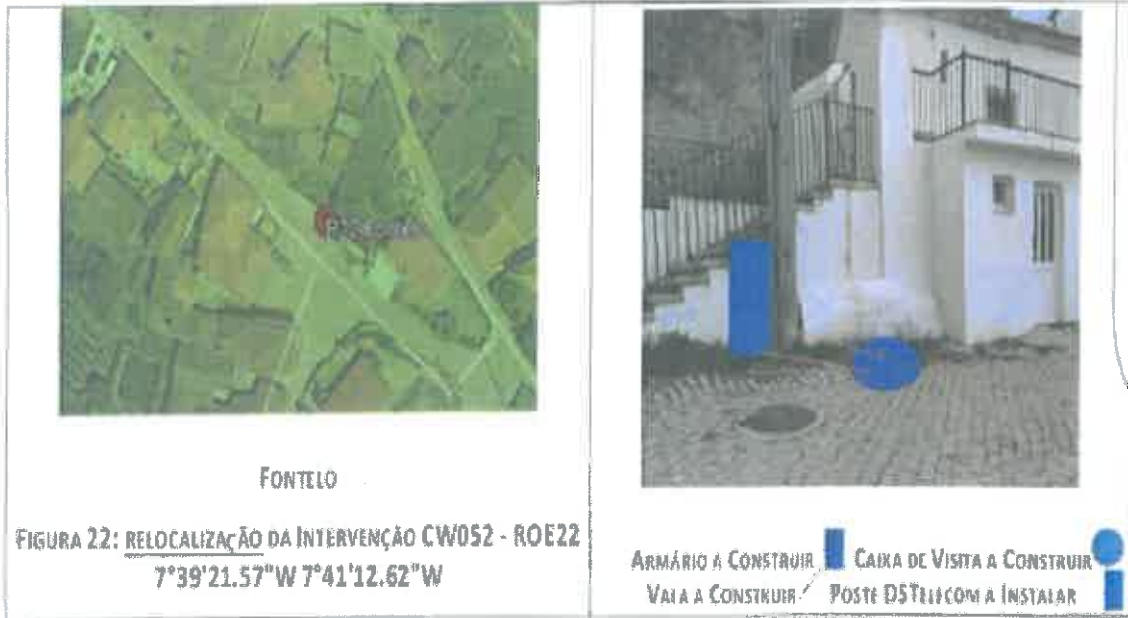
Imagem 21 – Fontelo – Intervenção CW052 – ROE22: Colocação de armário de distribuição de fibra ótica, construção de caixa de visita permanente, tudo pertencente à Derivadas e Segmentos, SA., abertura e fecho de valas de interligação entre a caixa de visita a construir, o armário a colocar e o poste EDP existente, bem como a passagem de cabo em infraestruturas existentes.
