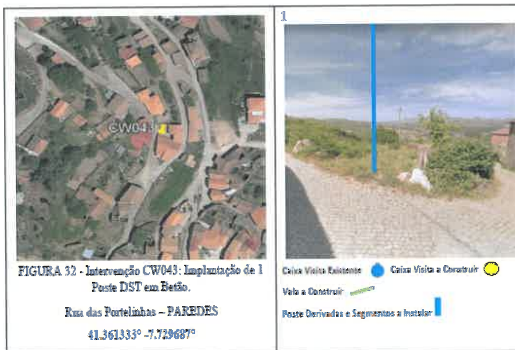
Imagem 129 – Rua das Portelinhas – Paredes
