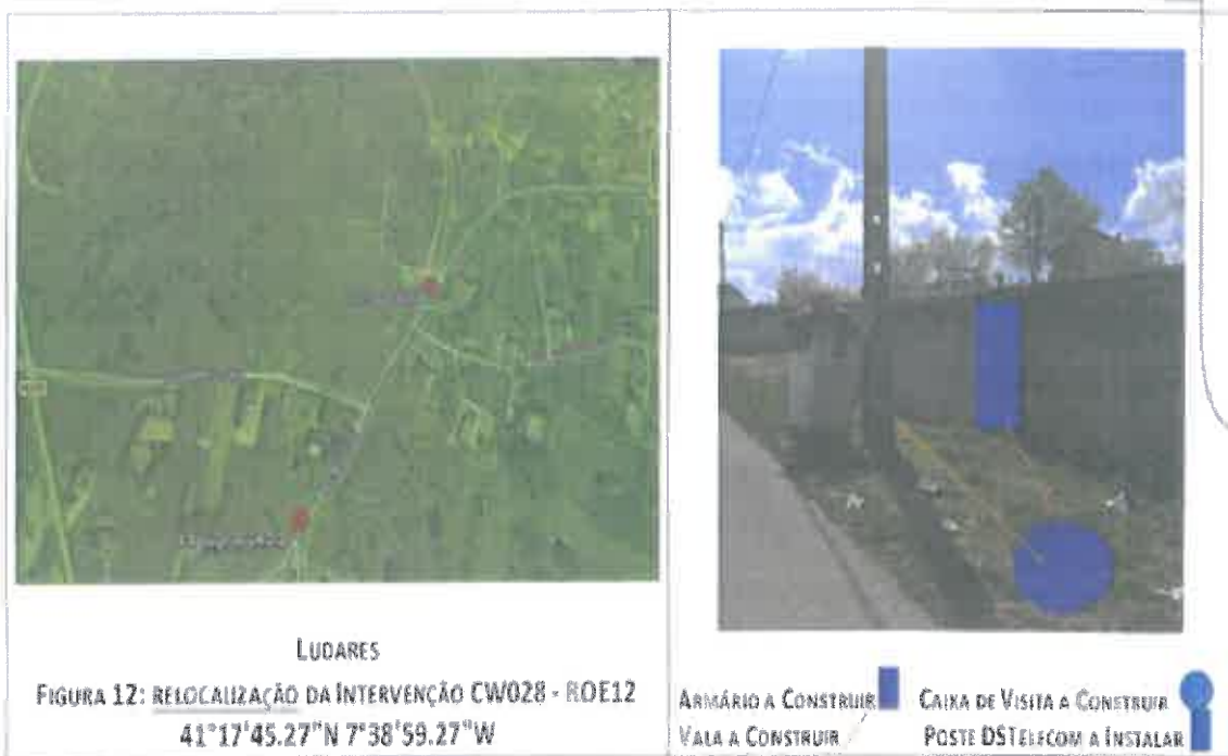
Imagem 12 – Ludares – Intervenção CW028 – ROE12: Colocação de armário de distribuição de fibra ótica, construção de caixa de visita permanente, tudo pertencente à Derivadas e Segmentos, SA., abertura e fecho de valas de interligação entre a caixa de visita a construir, o armário a colocar e poste EDP existente, bem como a passagem de cabo em infraestruturas existentes.
