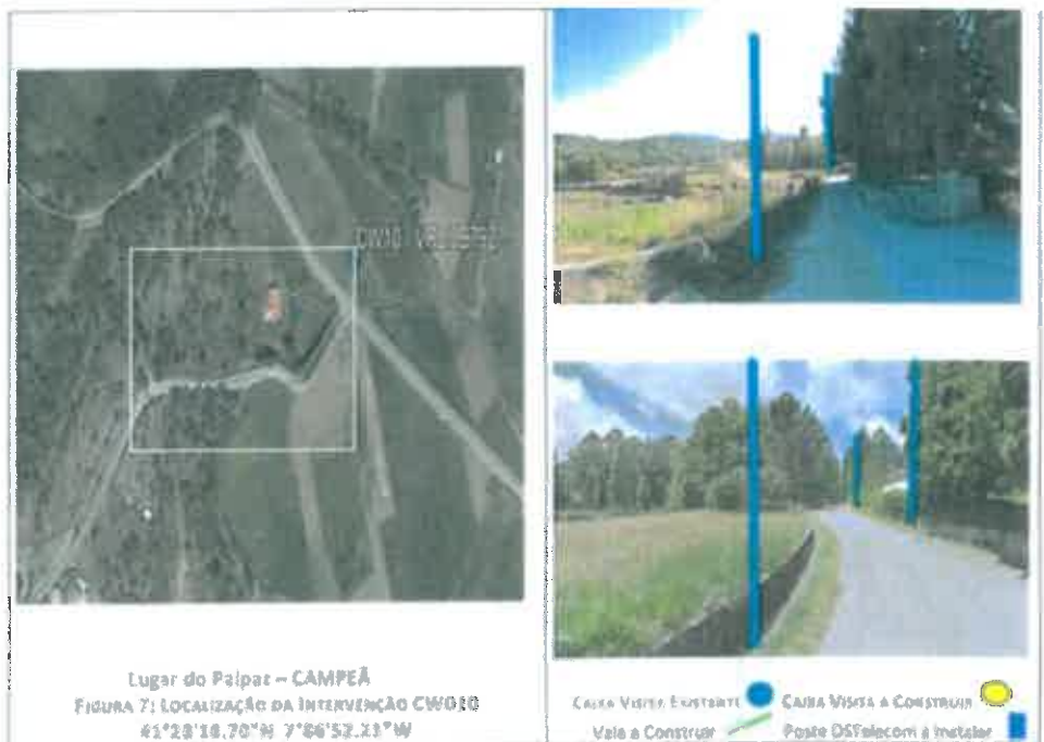
Imagem 8 – Intervenção CW010 – Implantação de 5 Postes DST em Betão
