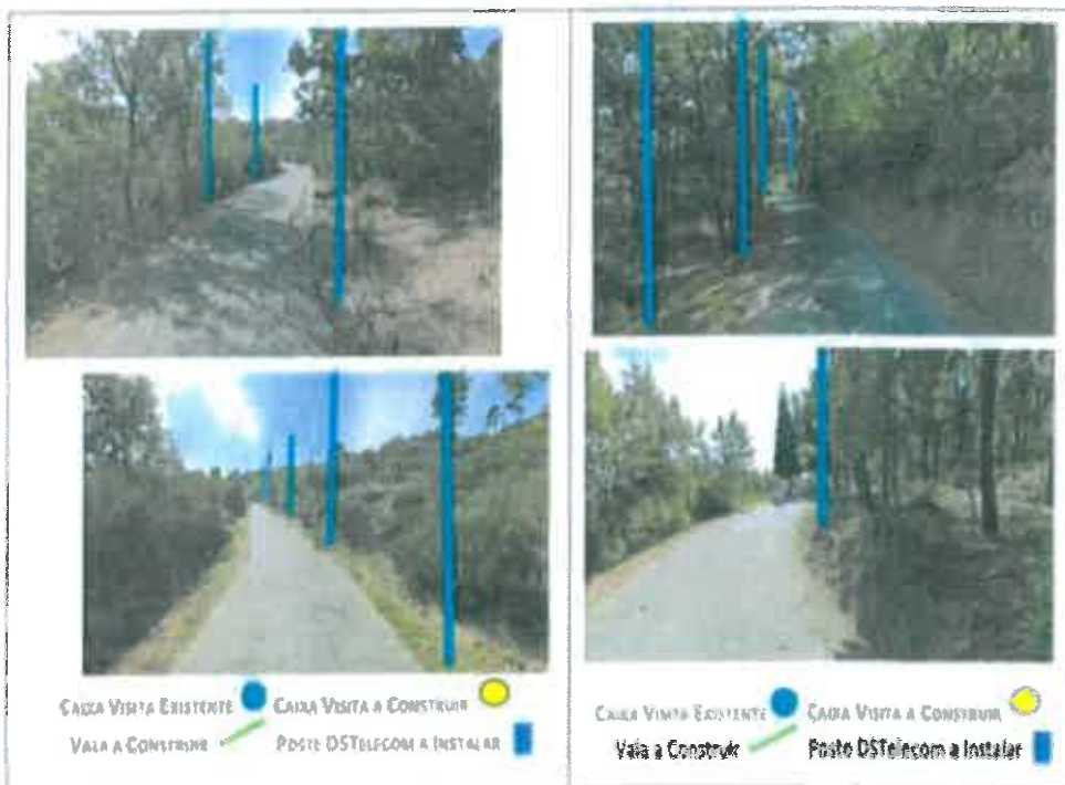
Imagem 5 – Intervenção CW004: Implantação de 16 Postes DST em Betão.
