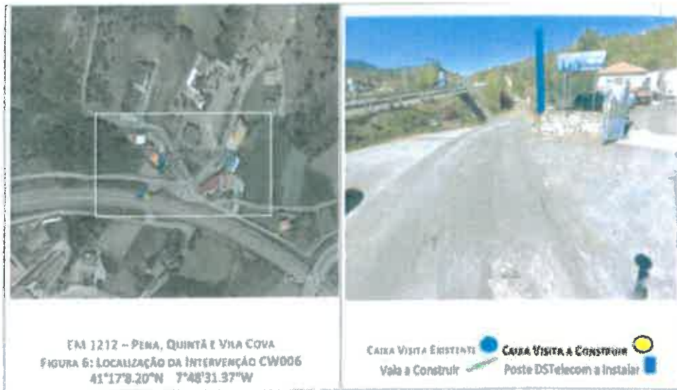
Imagem 7 – Intervenção CW006 – Implantação de 1 Poste DST em Betão
