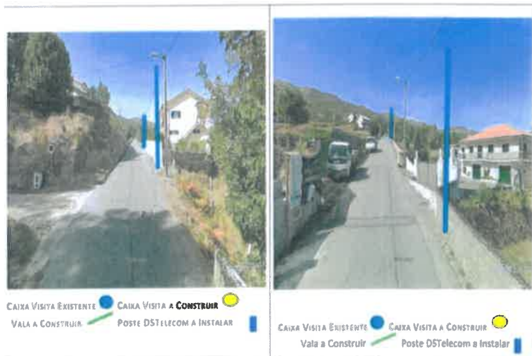
Imagem 4 – Intervenção CW003: Implantação de 6 Postes DST em Betão
