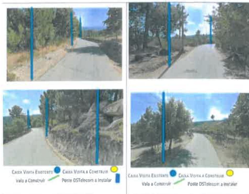
Imagem 6 – Intervenção CW005: Implantação de 14 Postes DST em Betão.
