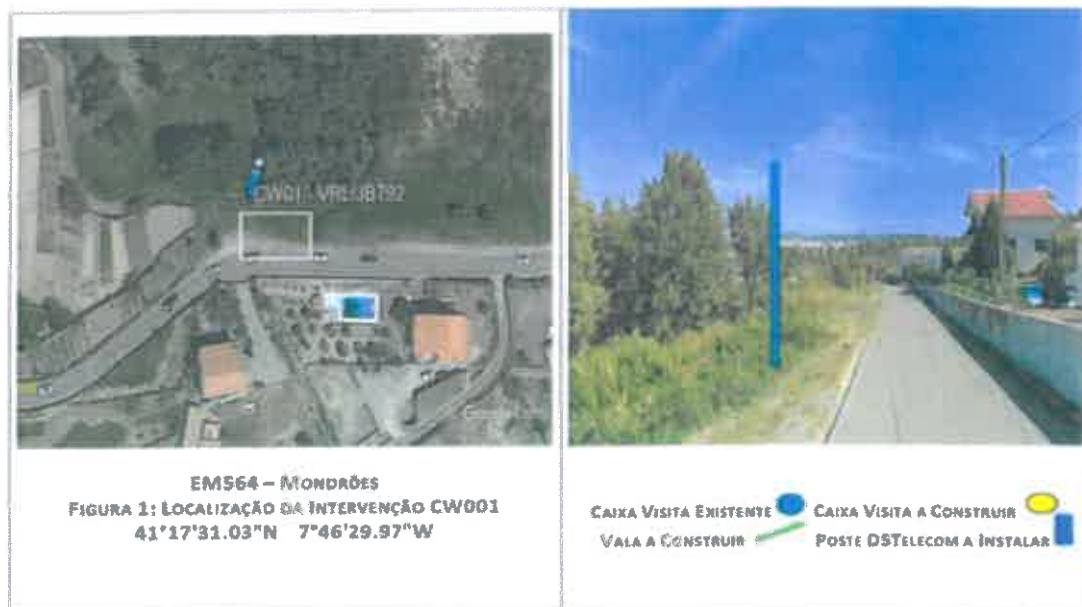
Imagem 2 – Intervenção CW001: Implantação de 1 Poste DST em Betão.
