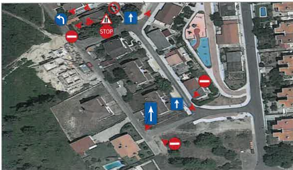
Fig. 9 – Colocação de sinalização vertical para os sentidos de circulação
