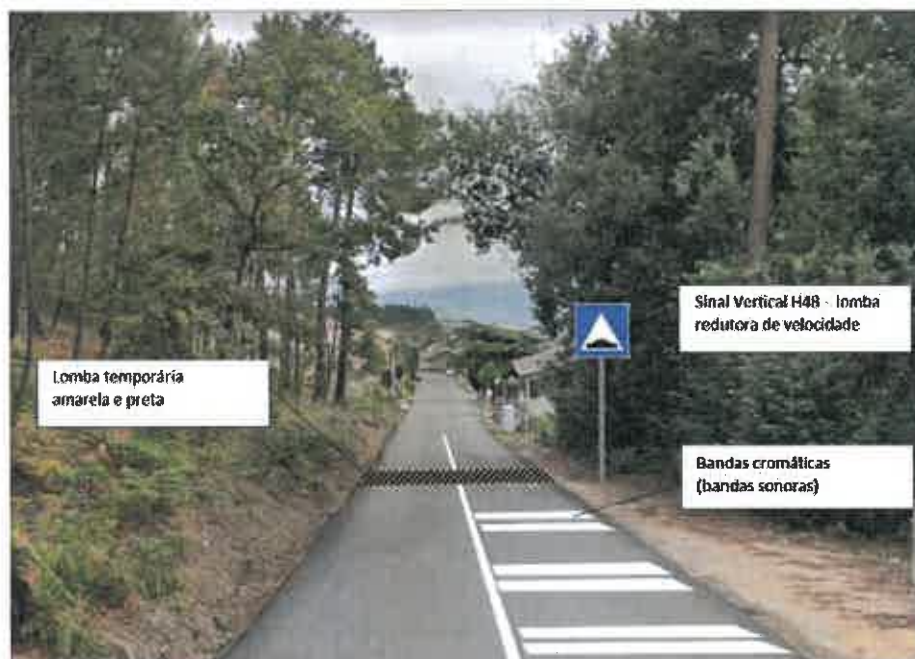
Fig. 5 Vista esquemática dos meios de sinalização a implementar. Fonte CM Vila Real
