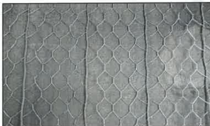
Fotografia 11 – Cabos de aço retos de 8,0mm de diâmetro tecidos no interior da malha hexagonal da rede metálica de tripla torção.
