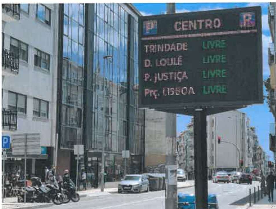
Fig. 43 Painel de mensagem variável com indicação da disponibilidade de estacionamento na cidade do Porto
