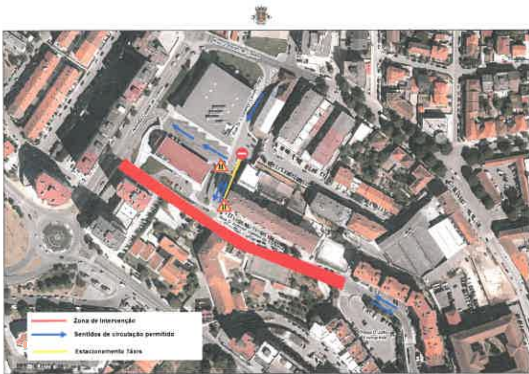
Fig. 1 – Desvio de trânsito para a pavimentação da camada Base entre a Praça D. João Evangelista e a Avenida Cidade de Orense (desvio em vigor)
